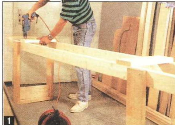
1 Для изготовления каноэ собственными силами нужно иметь сухое отапливаемое помещение площадью, достаточной для сборки каркаса выбранных вами размеров, чертеж лодки и материалы для стапеля, набора и обшивки корпуса.
